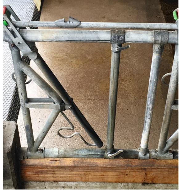
Zur einfachen Befreiung des betäubten Tieres wurden am Fressgitter zwei Schnellspannverschlüsse an der normalerweise festen Längsstrebe angebracht. Diese ermöglichen ein einfaches Verschieben und somit Vergrössern des Halsbereichs.
