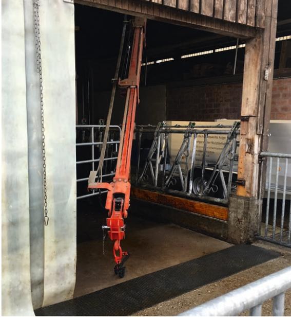
Der für die Betäubung eingerichtete Fressplatz mit dem Heukran und der Kette zum Aufhängen des betäubten Rindes.
