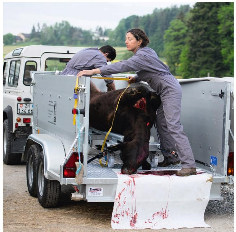
Der für Weideschlachtungen in Deutschland angefertigte T-Trailer besteht grösstenteils aus Aluminium und entspricht den Vorgaben der EU-Hygieneverordnung. Er kann sowohl an einen PKW als auch an einen Traktor angehängt werden. Der Anhänger eignet sich auch für den Transport von Tieren aus Hofötung.
